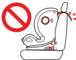
上拉带上的固定钩与汽车上的锚点需固定好，以免发生危险
