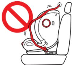
如使用正向安装（安全带固定）的方式固定座椅，安全带需确保收紧
