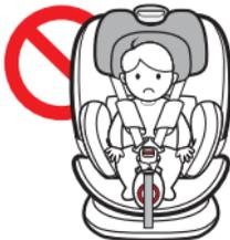
安全座椅肩带孔应比您孩子的肩部略高一点。头枕高度应停留在合适位置
