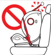
如果您的汽车安全带有损坏请停止使用，或把安全座椅安置在安全带完好的位置上
